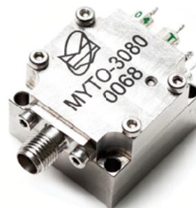
ЖИГ-генераторы МУТО-3080 — рекордсмены по совокупности фазовой стабильности и диапазона перестройки частоты. Они способны сохранять умеренно низкий фазовый шум сигнала при перестройке частоты более чем в три раза. Этот эффект достигается благодаря использованию монокристаллического ферромагнитного резонатора из железо-итриевого граната.
